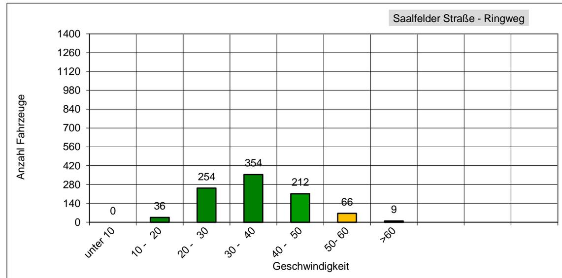
**v85:** Dieser Wert wird in km/h ausgegeben und bedeutet, dass 85% der gemessenen Fahrzeuge diese Geschwindigkeit nicht überschritten haben. Dieser Wert ist maßgeblich für ggf. weitere verkehrsrechtliche Maßnahmen. Je näher der Wert der v85 an der zulässigen Höchstgeschwindigkeit am Messort liegt, desto besser.
